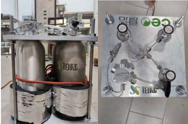
固态储氢瓶组储氢量250g
