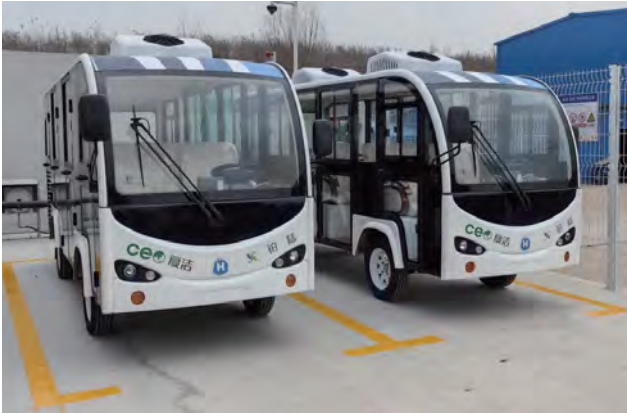
固态储氢罐储氢量1.0kg，燃料电池功率5kw
